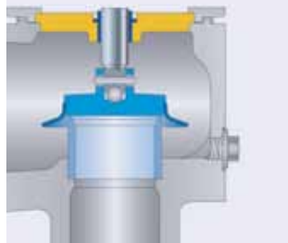
Диск с уплотнительной пластиной J44: PTFE-FDA J48: PCTFE J49: SP
